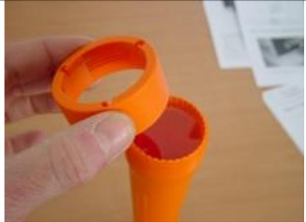
Visser l'écrou n° 6 sur l'extrémité du tube jusqu'en fin de course sans toutefois forcer.
