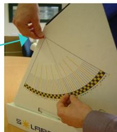
Ce système vous permet de lire directement en degré l'angle d'inclinaison du Solarscope.
