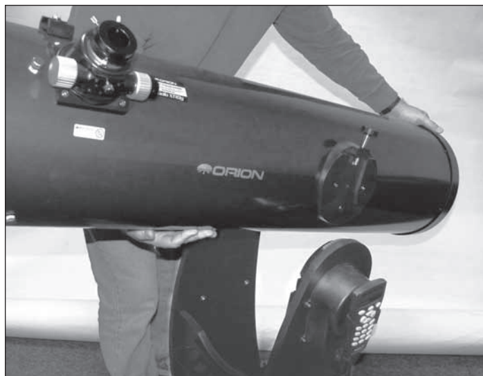
Figura 18. Sostenga el tubo del telescopio como se muestra, con una mano en el anillo del extremo posterior y la otra situada debajo del tubo; baje con cuidado el telescopio de manera que el rodamiento lateral de cola de milano del tubo encaje en el muñón metálico del panel lateral izquierdo.
