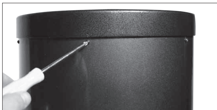
Figura 12. Para quitar el anillo del extremo posterior, desenrosque los seis tornillos que lo conectan al tubo.
