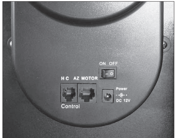
Figura 23. La carcasa del motor de altura tiene el interruptor de encendido ON/OFF y varios puertos para cables.
