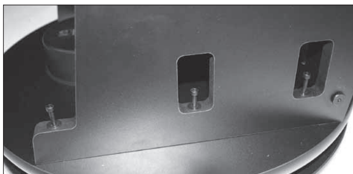
Figura 11. Tornillos de máquina de montaje de la base situados en su lugar, pero todavía sin apretar.
