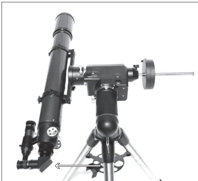
Figure 7. Exercez une légère pression horizontale sur le télescope afin de déterminer la direction du décalage de l'axe optique.
