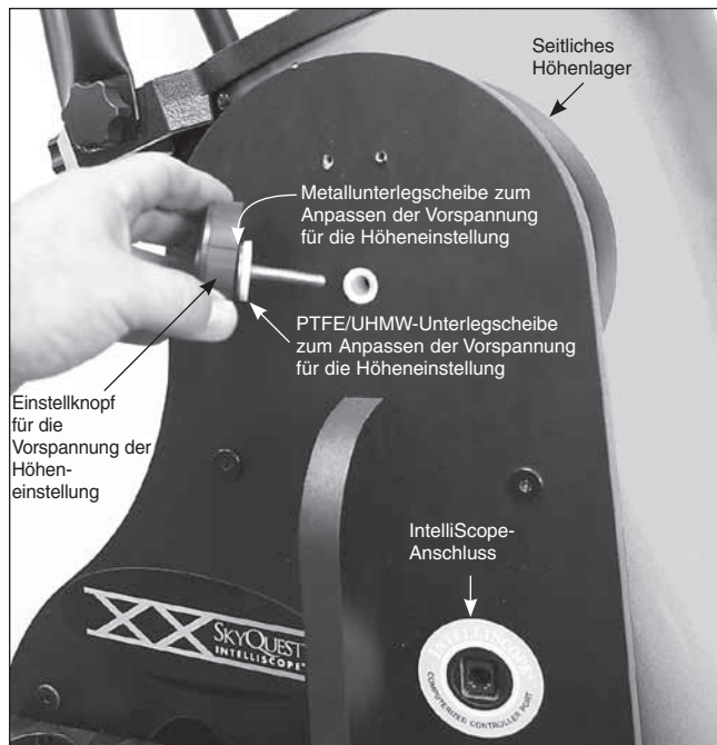
Abbildung 25. Der Einstellknopf für die Vorspannung der Höheneinstellung wird zusammen mit den metallenen und PTFE/UHMW-Unterlegscheiben an der Seitenwand mit dem IntelliScope-Anschluss in das seitliche Höhenlager am Optiktrohr geschraubt.
