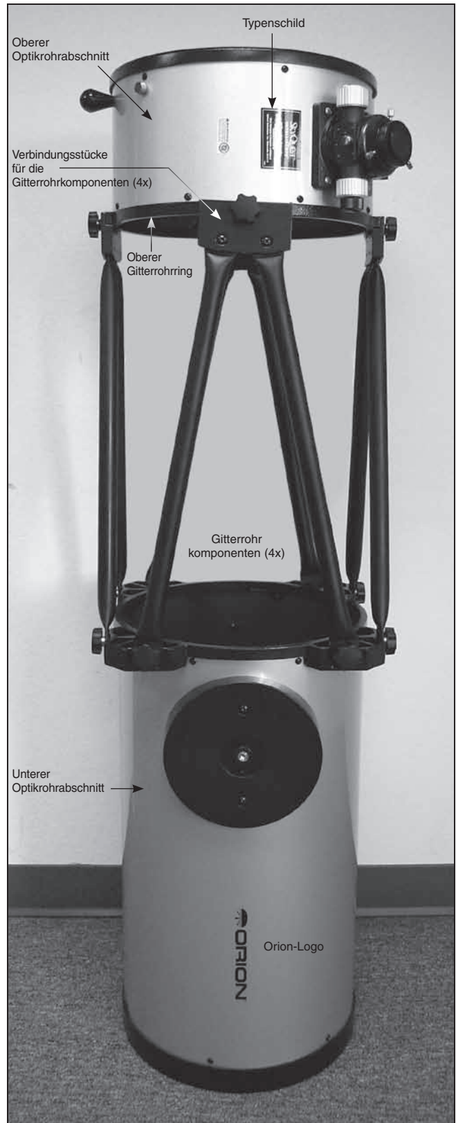
Abbildung 22. Nachdem das Optikrohr montiert wurde, sollte der obere Optikrohrabschnitt wie in der Abbildung gezeigt zum unteren Abschnitt ausgerichtet sein. Beachten Sie dabei die Ausrichtung des Typenschildes am oberen Optikrohrabschnitt zum Orion-Logo auf dem unteren Optikrohrabschnitt.
