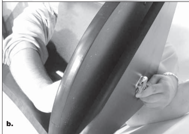
Figura 8. Quando si montano le piastre base, inclinarle leggermente, come mostrato, senza appoggiarle su un lato. (a) Utilizzare una chiave (o pinze) per tenere fermo il dado esagonale (b) mentre si gira la testa esagonale del bullone dell'asse azimutale con un'altra chiave.
