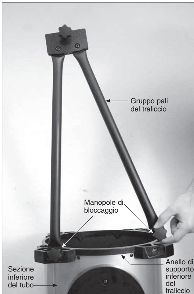
Figura 21. Le manopole di bloccaggio alle estremità dei pali del traliccio devono essere infilate nei fori sull'anello di supporto inferiore del traliccio sulla sezione inferiore del tubo.
