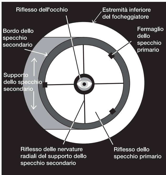
Figura 31. Collimazione delle ottiche. (a) Se gli specchi sono allineati correttamente, l'immagine attraverso il tubo interno del focheggiatore dovrebbe assomigliare a quella illustrata. (b) Con il tappo di collimazione applicato, se l'ottica non è allineata, l'immagine potrebbe assomigliare a quella illustrata. (c) In questo caso lo specchio secondario è centrato sotto il focheggiatore, ma deve essere regolato (inclinato) in modo che l'intero specchio primario sia visibile. (d) Lo specchio secondario è allineato correttamente, ma lo specchio primario ha ancora bisogno di regolazione. Quando lo specchio primario è allineato correttamente, il punto risulta centrato, come in (e).
