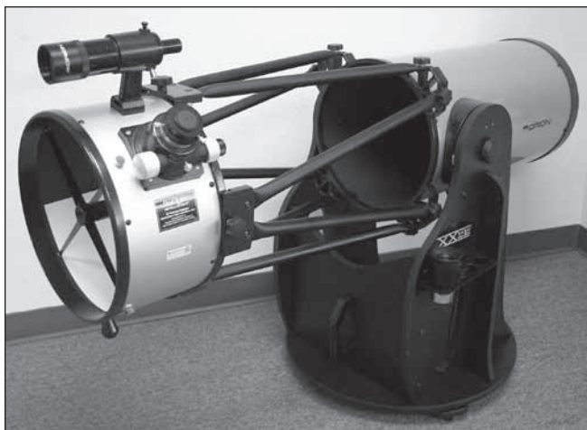
Figura 32. Configurazione del telescopio XX12 per la collimazione, con un pezzo di carta bianca di fronte al foccheggiatore e il tubo ottico a livello. Se possibile, il telescopio dovrebbe puntare verso un muro bianco.
