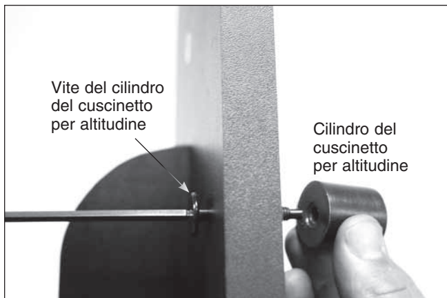
Figura 9. Infilare una vite del cilindro del cuscinetto attraverso il pannello laterale e avvitare al cilindro del cuscinetto per l'altitudine. L'estremità smussata del cilindro deve essere rivolta dalla parte opposta rispetto al pannello laterale.
