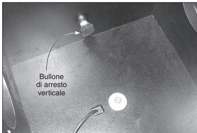
Figura 14. Avvitare il bullone di arresto verticale, con le rondelle inserite, nella sede filettata sulla piastra frontale.
