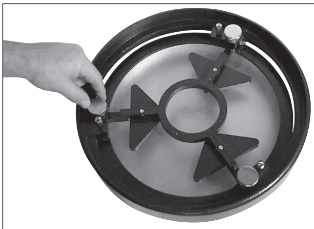
Figura 36. È possibile regolare l'inclinazione dello specchio primario girando una o più delle tre manopole di collimazione.
