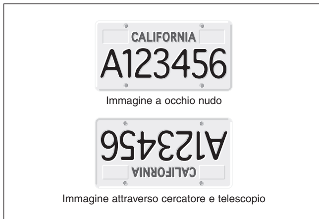
Figura 40. L'immagine attraverso un telescopio riflettore o un cercatore dritto risulta ruotata di 180°. Questo accade anche con il telescopio XX12 e il relativo cercatore.
