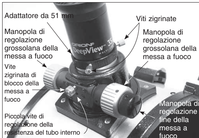
Figura 29. Oculare DeepView da 51 mm installato nel focheggiatore.
