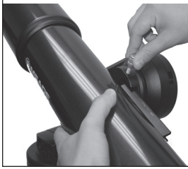
Abb. 7: Sechsheiniger Schwalbenschwanz am Montierungsarm befestigen.
