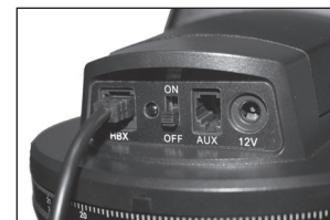
Abb. 13: Verbinden Sie AudioStar mit dem HBX-Anschluss.
