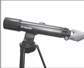
Abb. 8: Ausbalancieren des optischen Tubus.
