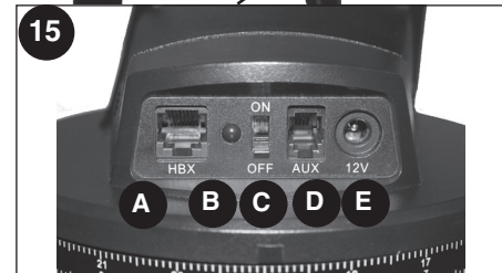
Abb. 1c (Vergrößerung): Computer-Bedienfeld. (A) Handbox-Anschluss; (B) Betriebsanzeigeleuchte, (C) Einschalter; (D) Hilfsanschluss; (E) 12V
