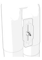
Passaggio 3. Installazione del gruppo del passaggio 2 sulla montatura. Posizionare il gruppo assemblato nel passaggio precedente sulla piattaforma inferiore (n. 3), quindi serrare nuovamente le due viti ad alette della piattaforma (n. 5).
