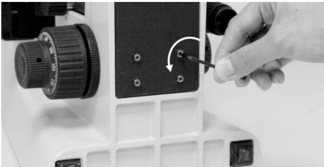
2. Schrauben Sie die vier Inbusschrauben ab, die die hintere Abdeckplatte halten. Die Leiterplatte befindet sich hinter der hinteren Abdeckplatte.
