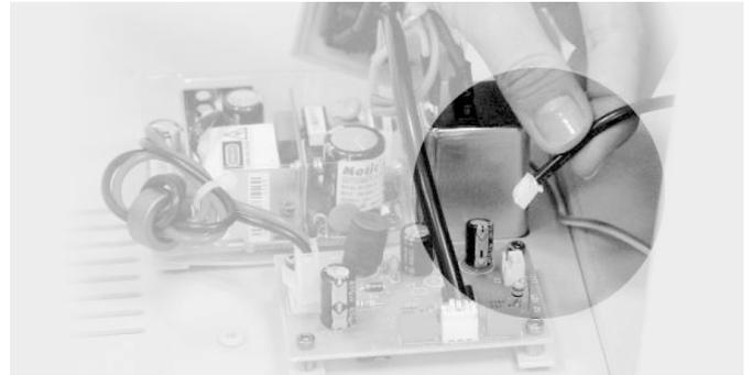
5. Montieren Sie die neue LED.
