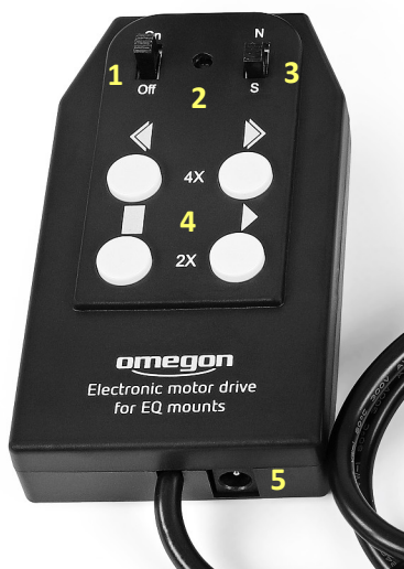
Abbildung 4 1 On/Off, 2 rote LED, 3 Nord/Süd-Umschalter, 4 Tastenfeld für Motorgeschwindigkeiten, 5 Anschluss für Batteriefach
